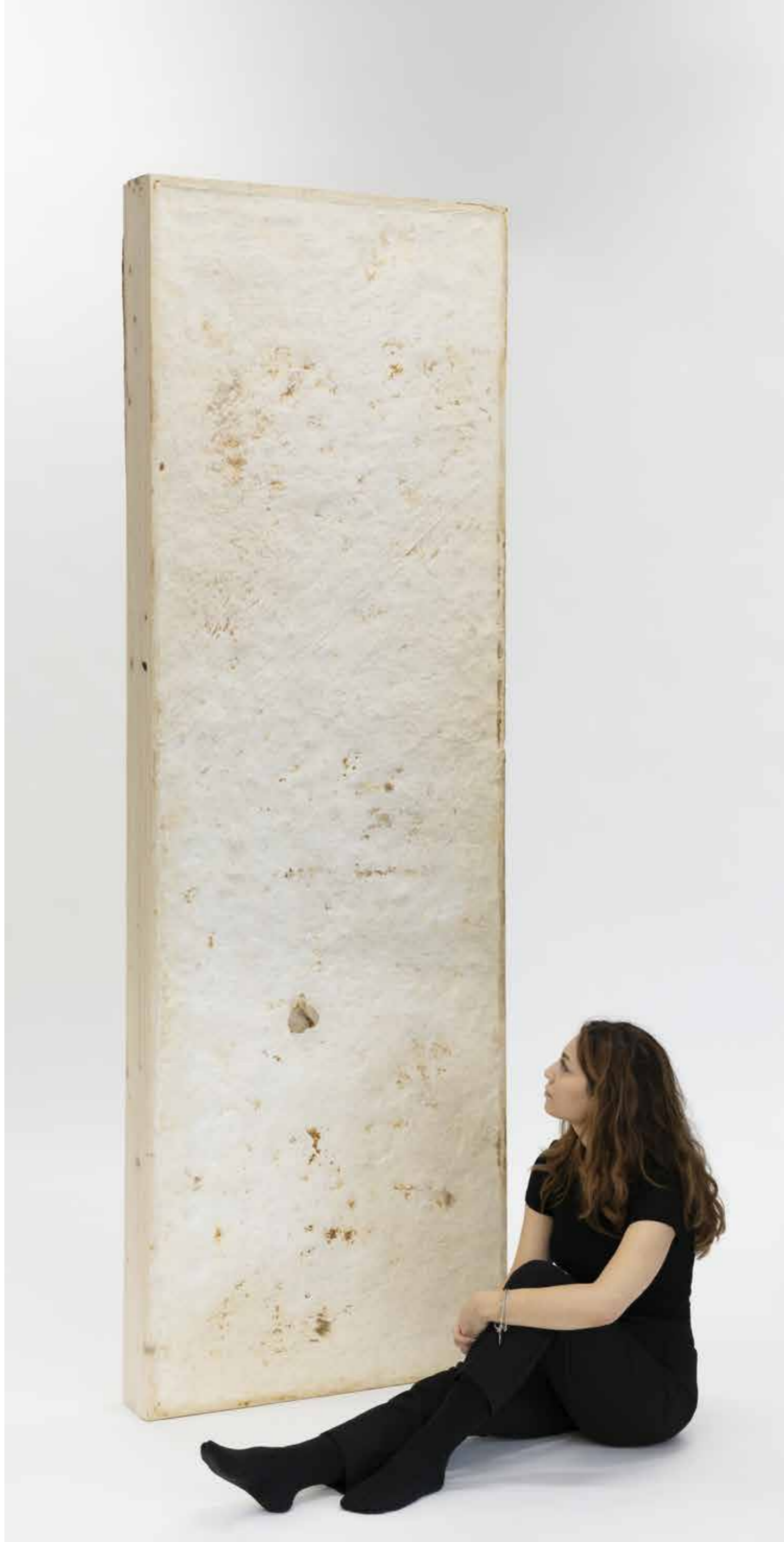
AHŞAP KAPLI AMA TAKVİYELİ DÜZ BÖLME DUVAR. EDEK, KASSEL ÜNİVERSİTESİ, 2022. FOTOĞRAF: NICOLAS WEFERS VENEER-REINFORCED FLAT PARTITION WALL. EDEK, UNIVERSITÄT KASSEL, 2022. PHOTO: NICOLAS WEFERS
